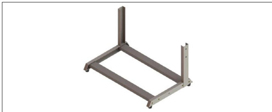
Abb. 5 – Schritt 3: Montage des Untergestells
