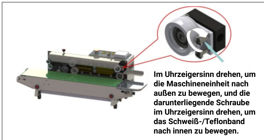
Abb. 10 – Korrektur des Teflonbandlaufs
