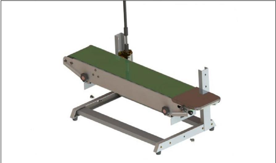
Abb. 6 – Schritt 4: Befestigung des Fördertisches am Gestell
