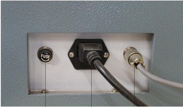
Sicherung      Stromanschluss      Anschluss Fußschalter
