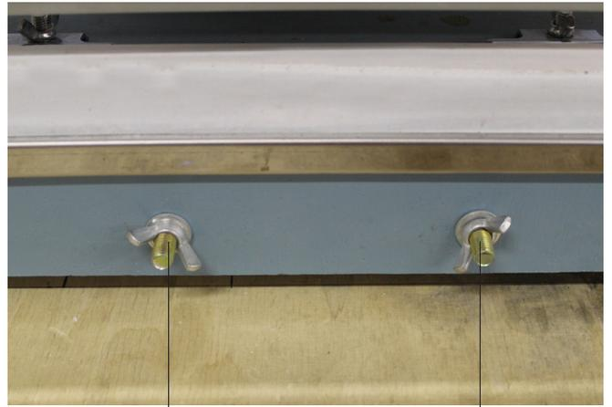
Flügelmuttern zur Befestigung des Ablagetisches
